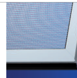
■ Variante RS "Aluminium-Rundlochblech" Torflügel als Rahmensprossenkonstruktion (RS) aus Aluminiumprofilen, Feldereinteilung beliebig wählbar, Füllung aus Aluminium-Lochblech RV 5/8, E6 / EV 1 eloxiert, (Lüftungsquerschnitt der Füllung ca. 35 %, Gesamt Lüftungsquerschnitt geringer – muss im Einzelfall berechnet werden).
