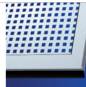
■ Variante RS "Quadratlochblech" Torflügel als Rahmensprossenkonstruktion (RS) aus Aluminiumprofilen, E6 / EV1 eloxiert, Feldereinteilung beliebig wählbar, Füllung aus Aluminium-Quadratlochblech QG 20/50, E6 / EV1 eloxiert, (Lüftungsquerschnitt der Füllung ca. 16 %, Gesamt Lüftungsquerschnitt geringer – muss im Einzelfall berechnet werden).
