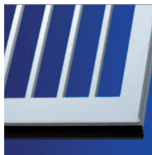
■ Variante QR Stabgitterfüllung QR aus Aluminium-Quadratrohr 20 x 20 mm, E6 / EV1 eloxiert, Lüftungsquerschnitt ca. 70 % (reduziert sich bei Einbau von Schlupftür auf ca. 60 %).
